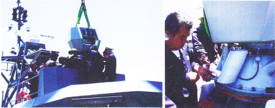
การติดตั้งระบบควบคุมการยิงรุ่น MIRADOR ให้กับ ชุดเรือ ต.๙๙๑
