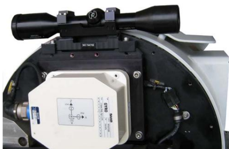
รูปภาพที่ ๑.๑ การติดตั้งกล้อง Telescope และ Differential Screw
