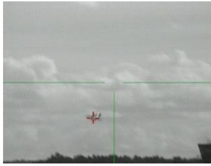
รูปภาพที่ ๑.๓๑ ตัวอย่างการระบุเป้าโดยอัตโนมัติของ Video Tracker
