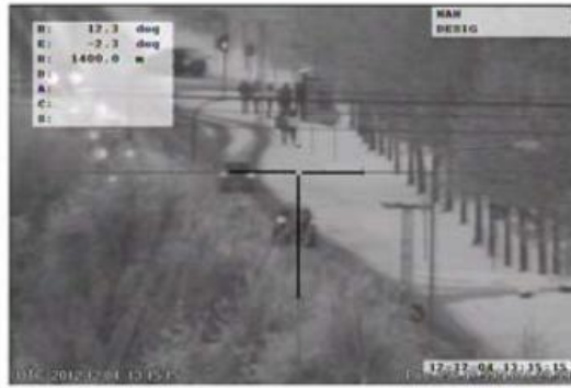
รูปภาพที่ ๑.๔ ตัวอย่างการเล็งจุดอ้างอิง (Crosshair) ของ TV Camera
